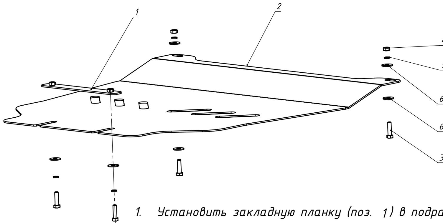
1. Установить закладную планку (поз. 1) в подрамник двигателя.
